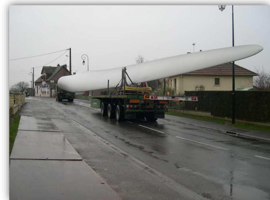
Photo 32 : Camion de transport des pales d'une éolienne
